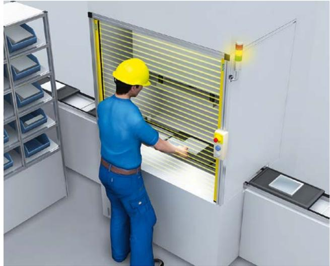
1-Takt-Betrieb an einem Montageautomaten mit Sicherheits-Lichtvorhang. Beim Einlegen befindet sich das Werkzeug im oberen Punkt. Nach Freigabe des Schutzfelds durch den Bediener wird der Montageprozess eingeleitet.
