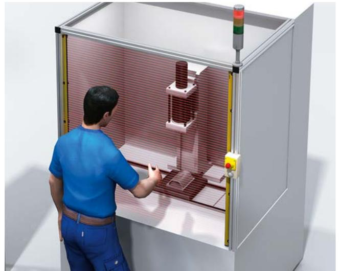
Gefahrstellenabsicherung mit einem Sicherheits-Lichtvorhang
