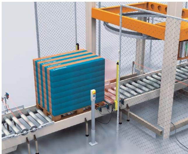
Muting-Funktion mit Sicherheits-Lichtvorhang und Muting-Sensoren an einer Folienwickelmaschine
