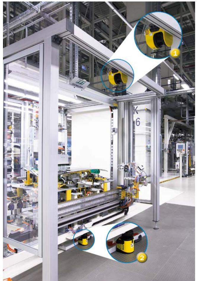
Sicherheits-Laserscanner an einer Bearbeitungsstation als Sicherheitsfunktion Pos. 1, Stopp auslösen und Sicherheitsfunktion Pos. 2, Start verhindern (Hintertretschutz)
