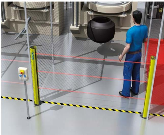
Zugangsabsicherung mit einer Mehrstrahl-Sicherheits-Lichtschränke
