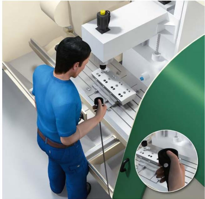
Der Maschinenstart darf nicht allein durch das Betätigen einer Zustimmeinrichtung ausgelöst werden. Vielmehr wird eine Bewegung nur so lange zugelassen, wie die Zustimmeinrichtung betätigt ist.
