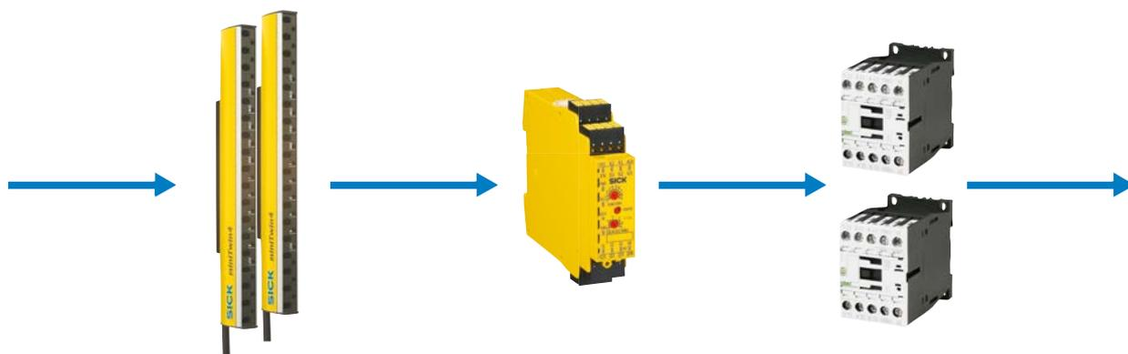
In der Praxis werden für bestimmte Sicherheitsfunktionen vielfach bereits zertifizierte Teilsysteme verwendet. Diese Teilsysteme können z. B. Lichtvorhänge aber auch Sicherheits-Steuerungen sein, für die bereits „vorgerechnete“ PL bzw. PFHd-Werte vom Hersteller der Komponente geliefert werden.
