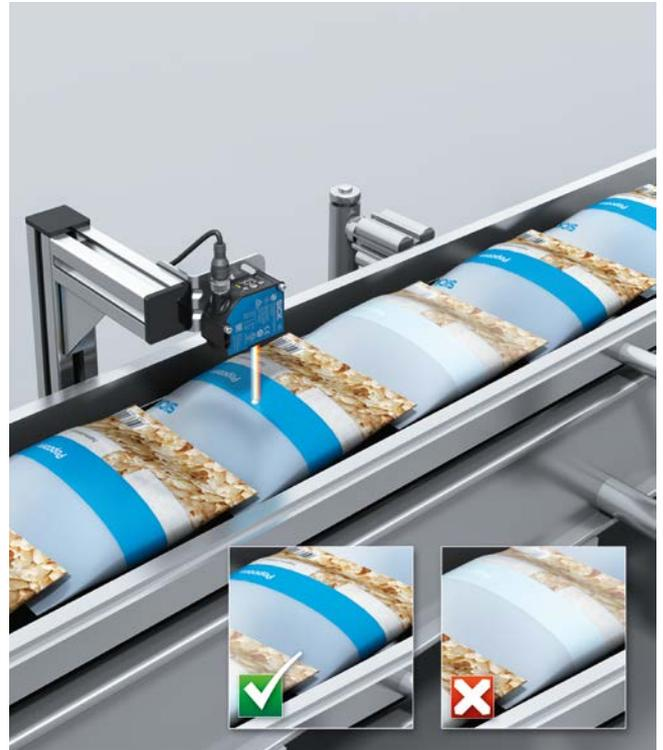
Erkennen fehlerhaft bedruckter Verpackungen.
